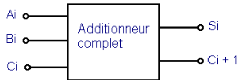
Représentation schématique d'un additionneur complet.
