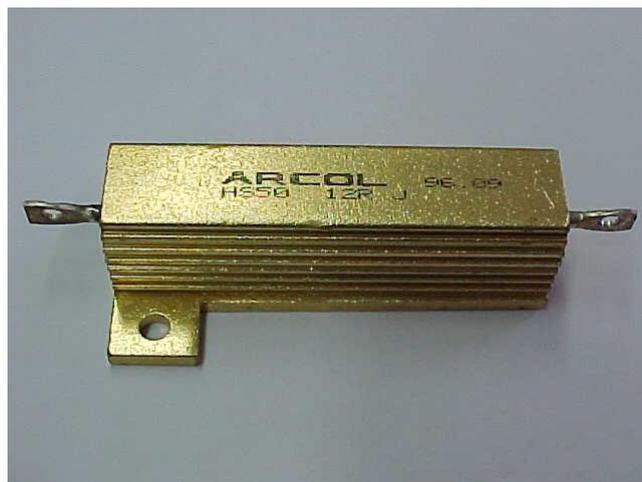
Fig. 8. Photo des résistances bobinées de puissance (Résistances de charge).
