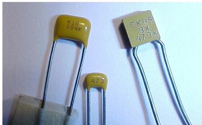
Fig.5. Photo des condensateurs céramiques multicouches.
