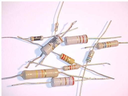
**Fig. 3.** Photo des résistances à couche de carbone.
