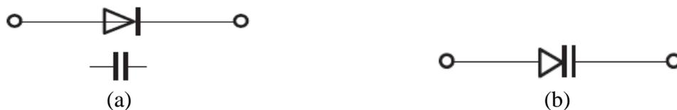
**Fig.30. (a)** Symbole normalisé d'une diode varicap ; **(b)** Autre symbole de la diode varicap.
