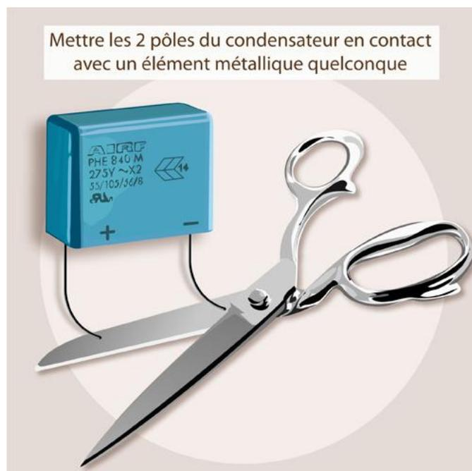
**Fig.22.** Opération de déchargement d'un condensateur.
