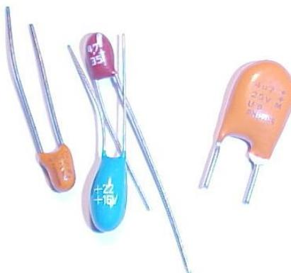
**Fig.7.** Photo des condensateurs électrolytiques au tantale.
